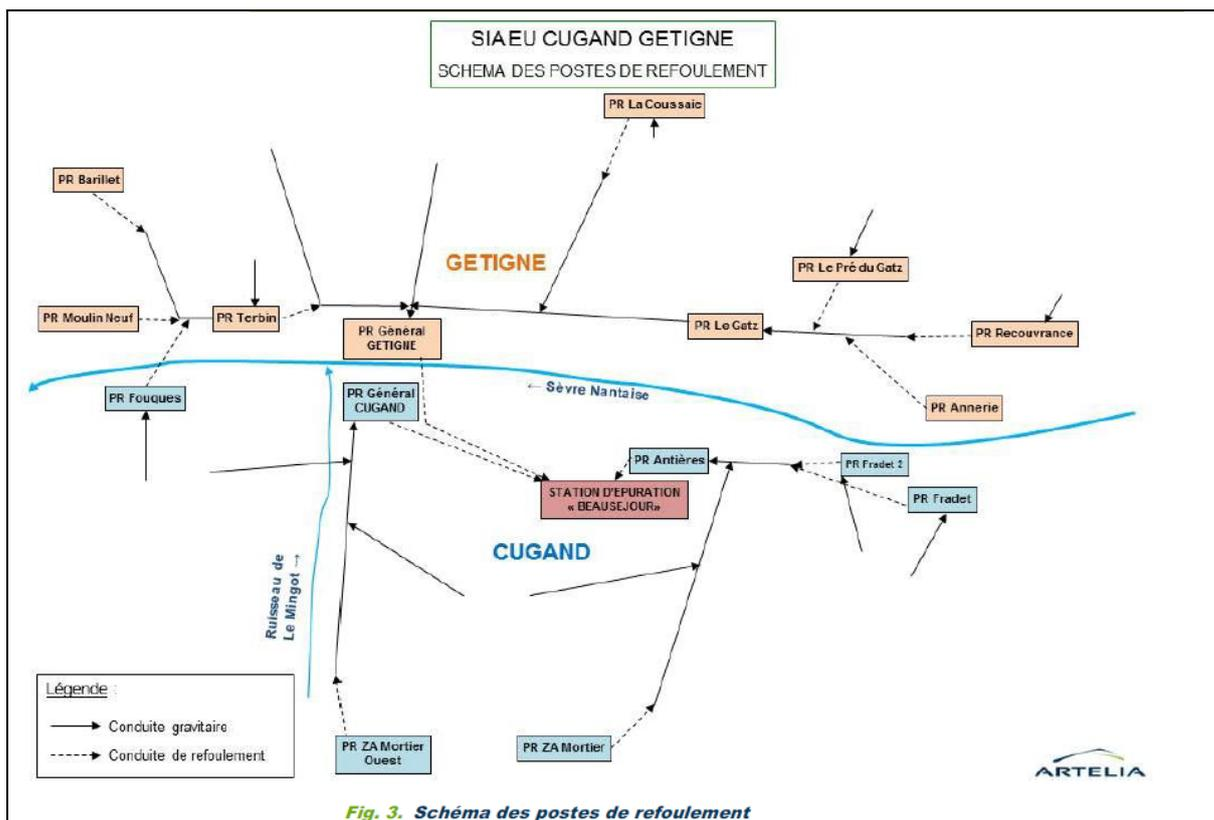
Deux plans pages suivantes présentent l'ossature du réseau sur la partie Cugand.
