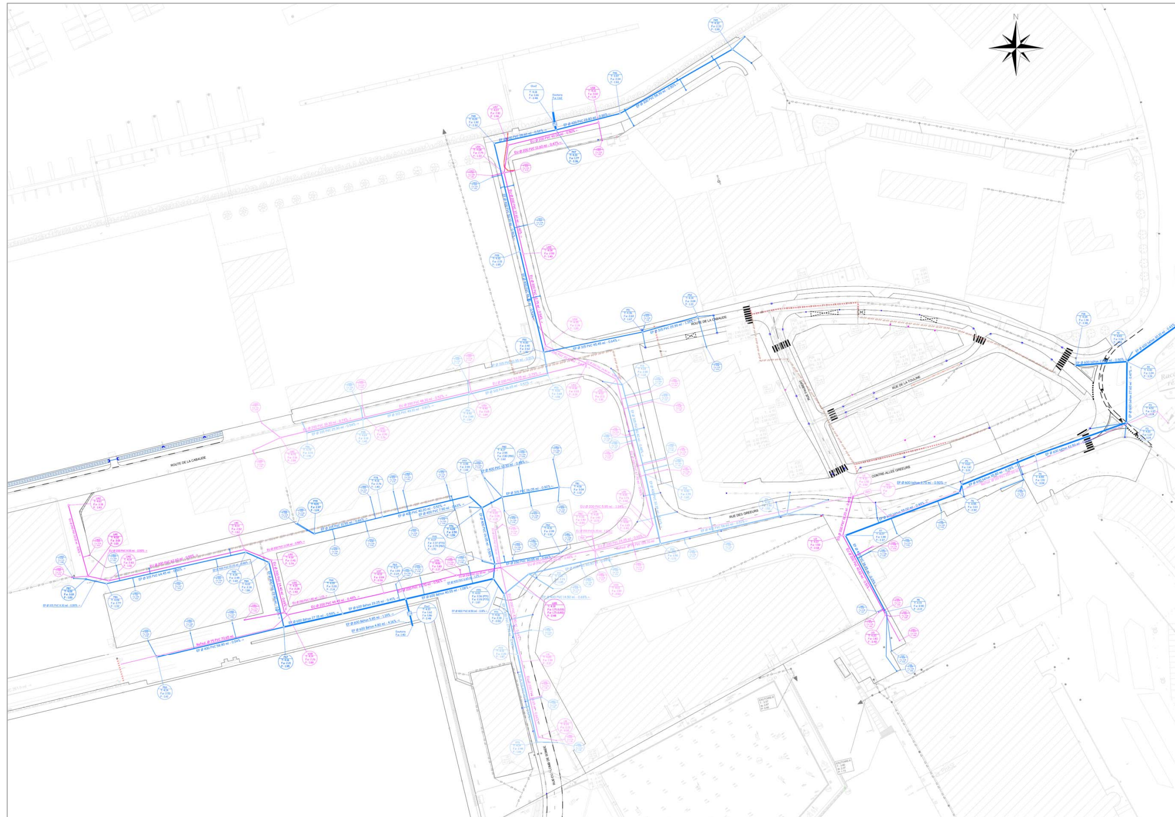
Annexe n°6 : Réseau d'eaux pluviales sur le port de commerce de la Cabaude (extrait plans de récolement)
