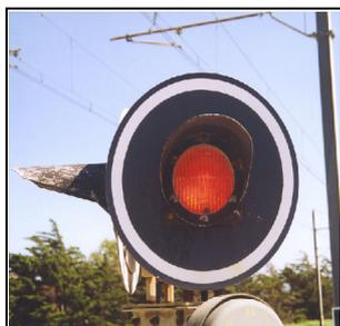
**Signal R24** : signal lumineux rouge clignotant imposant l'arrêt à tous les véhicules lorsqu'il s'allume. Un feu rouge, fixe ou clignotant, signifie aux véhicules l'interdiction de franchir le feu. **Ce feu rouge est aussi destiné aux piétons.**
