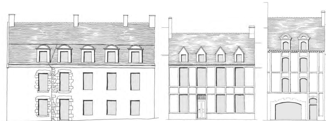
Hôtel au 4 place de la Psallete (lucarnes à fronton cintré restituées sur le dessin) ; Belles maisons à façade tramée au 21 rue Saint-Michel (percements du rez-de-chaussée restitués sur le dessin, lucarnes non d'origine) et au 15 rue Saint-Michel (1691, rez-de-chaussée modifié).
