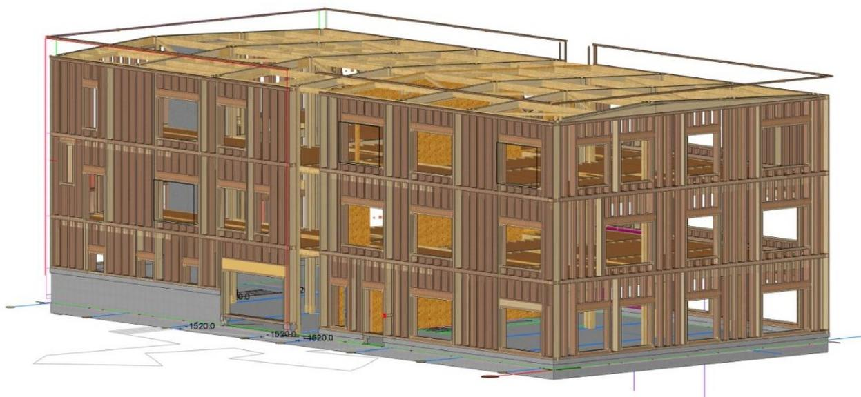
*Vue du squelette de l'ossature des murs caissons (CADWORK)*
